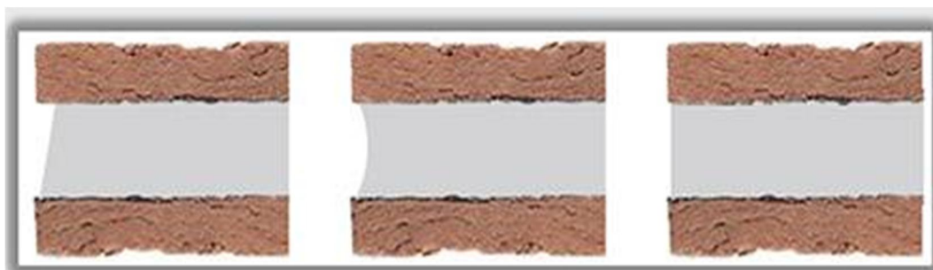
Рис. 1. Виды обработки швов старой каменной кладки: односрезная, вогнутая и вподрезку
